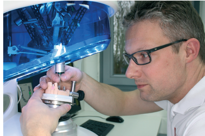
Zahntechnikermeister Ulrich Schloh beim Erfassen von individuellen Implantat-Abutments am taktilen Scanner.
